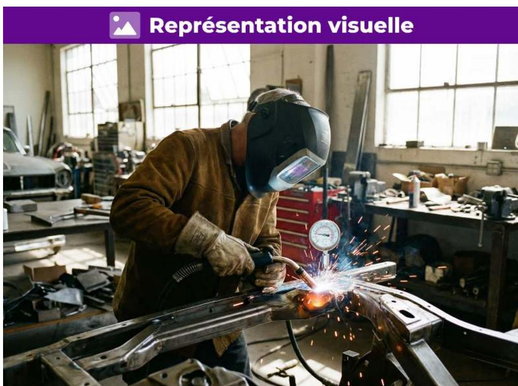
*Régler la soudure MIG à 80 A pour assurer une bonne pénétration sur tôle fine*
